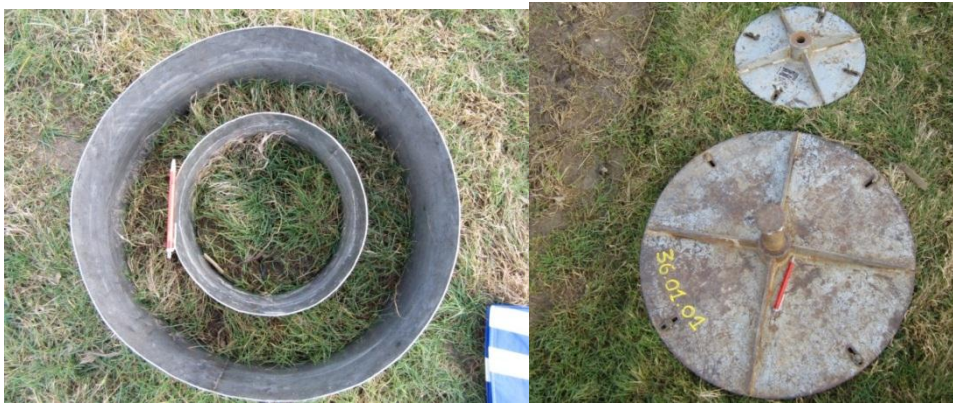
Figuur 5: opstelling dubbele-ringinfiltrometer
